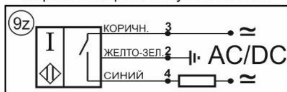
Цоколевка клеммной колодки
