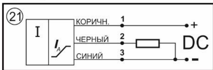
Схема соединения пропорциональный ток на выходе
